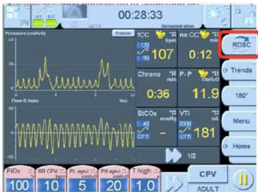
Figure 2. Courbe de pression (ventilation) sur laquelle se superposent les CT continues (réglages en rose en bas de l'écran.) Par défaut, ils répondent aux recommandations. Les pavés de monitoring indiquent la fréquence et la qualité des CT en plus de deux chronomètres et de l'EtCO 2 . La touche ROSC permet de repasser dans un mode conventionnel.
