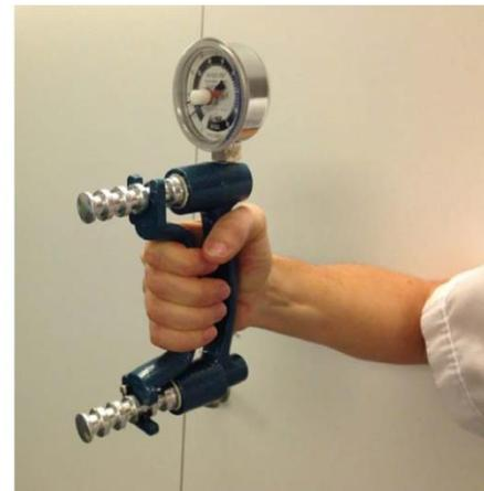
Fig. 1 Dynamomètre à poignée de type "handgrip"
